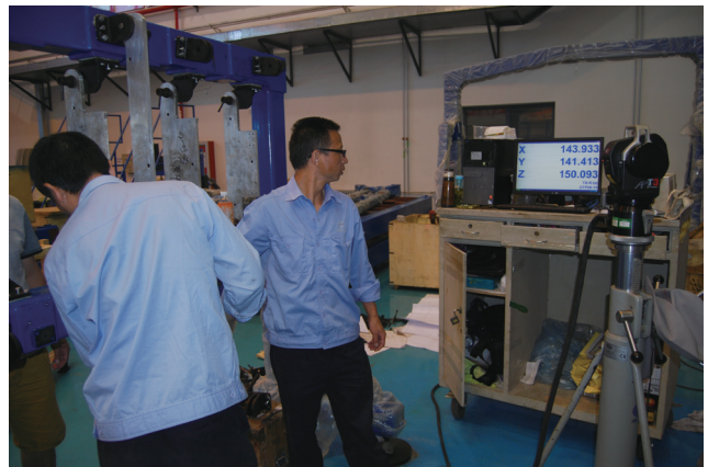
图3 定位精度在线调整现场
